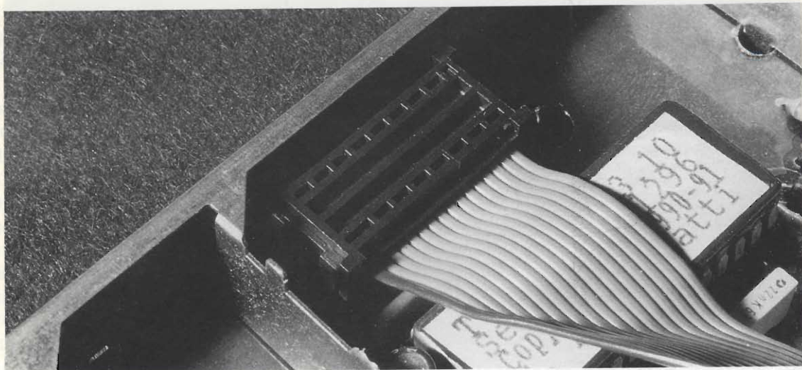
Particolare dell'installazione della piattina con i Contraves sul connettore femmina.
